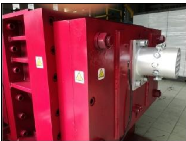
Attēls 11. Granulēšanas iekārtas ekstrūdera matrica.
